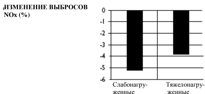
Рисунок 10: Влияние суммарного содержания ароматических углеводородов на выбросы NOx при снижении суммарного содержания ароматических углеводородов с 30% до 10%
