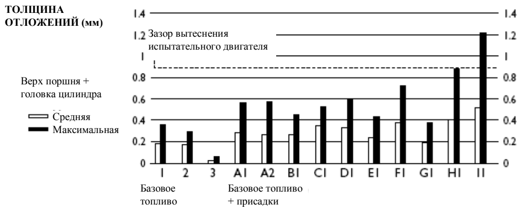
Рисунок 18: Характеристики бензинов по ОКС, нагрузочное испытание по методу «Ford 2.3L» по ASTM D 6201
