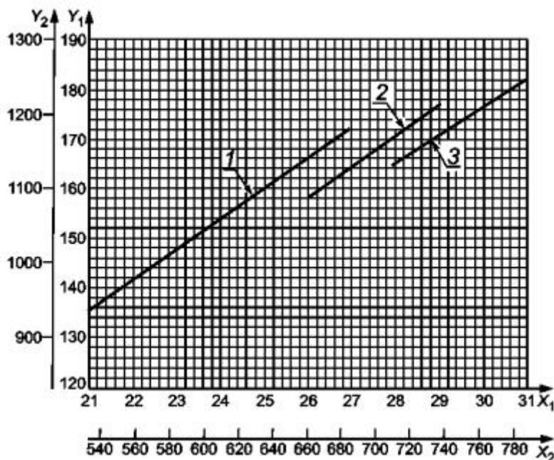
Примечание - Основная установка высоты цилиндра: цифровой счетчик - 930, шкала индикатора - 0,352 дюйма;  $X_1$  - барометрическое давление, дюймы рт.ст.;  $X_2$  - барометрическое давление, мм рт. ст.;  $Y_1$  - давление сжатия, избыточное давление в фунтах на квадратный дюйм;  $Y_2$  - давление сжатия, кПа
